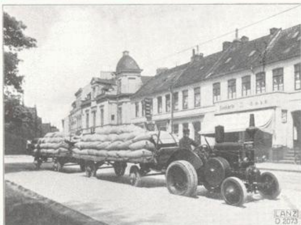
Der Großbulldog ersetzt im Dauerbetrieb 4 Paar schwere Pferde und zieht auf ebener, fester Straße eine Bruttolast von etwa 400 Zentner
