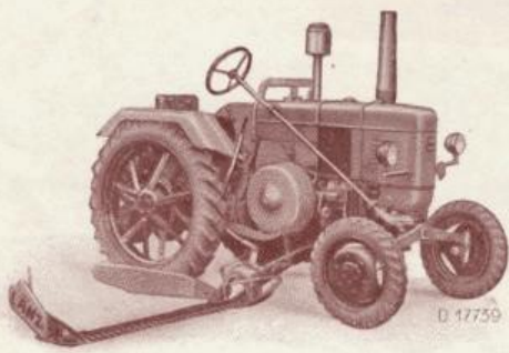
16 PS LANZ-Allzweck-Bauern-Bulldog mit Anbau-Grasmäher - Schnittbreite 4 1/2'
