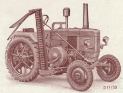
Aushebung mit Hand oder hydraulisch mit Kraftheber.
