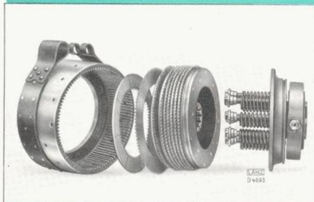
Lamellen-Lenkkupplung der Lanz-Bulldog-Raupe
