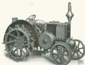
12/20 PS Acker-Bulldog der Kleinschlepper für den mittleren Betrieb
